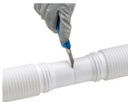
Κοπή του εύκαμπτου συστήματος μεταξύ 2 αρσενικών τμημάτων της κουλούρας (η κοπή μπορεί να γίνει πριόνι ή άλλο αιχμηρό κοπτικό εργαλείο εφόσον καθαριστούν τα γρέζια εν συνεχεία)
